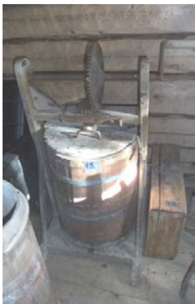
Kuva. Iljalassa käytetty kirnu. Se toimii ylhäällä oikealla olevaa kampea pyörittämällä. Käytössä oli muitakin pyörittämällä toimivia kirnuja
